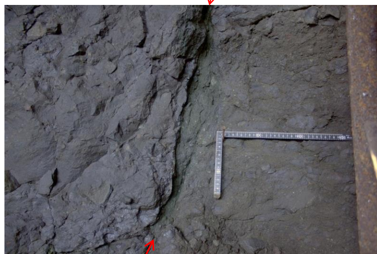
①変質鉍物脈と母岩の境界は直線的ではなく起伏が激しい。上方では脈幅が狭くなり、節理状となる。
