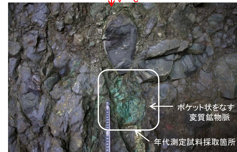
③変質鉍物脈は部分的にポケット状(軟質な緑色粘土鉍物を挟む)に厚くなるが、上下に節理状の細脈となる。
