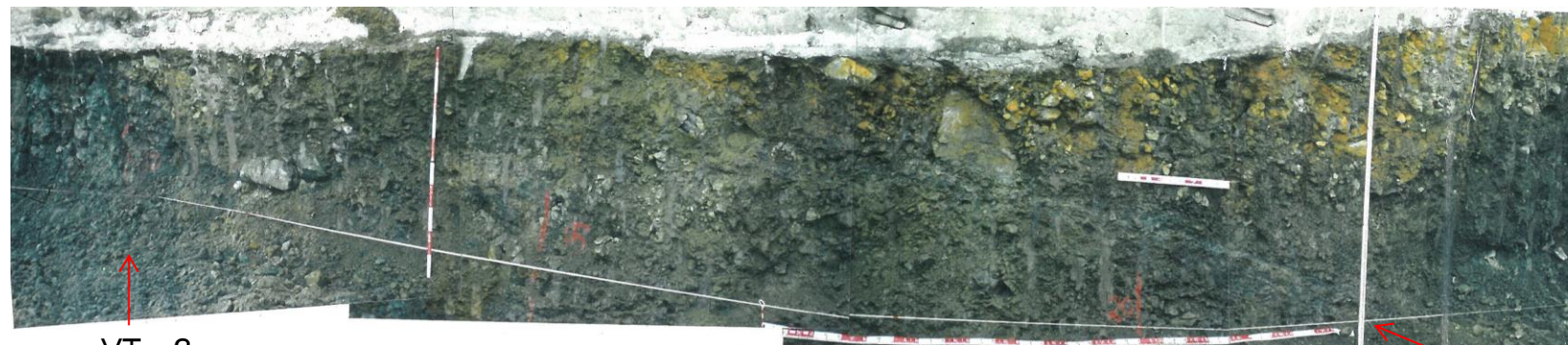
VT-2 ②タービン建屋北側法面写真（T.P.-2m～-4m） f-1断層
