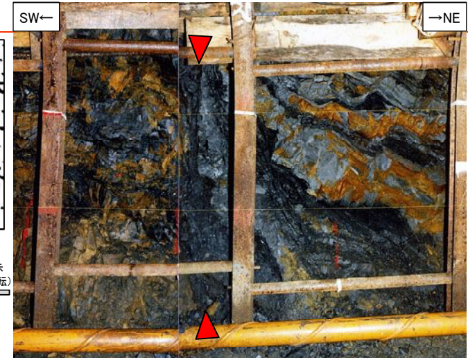
2号炉試掘坑B坑北西壁で確認したTF-2断層(左上:スケッチ, 右:写真)
