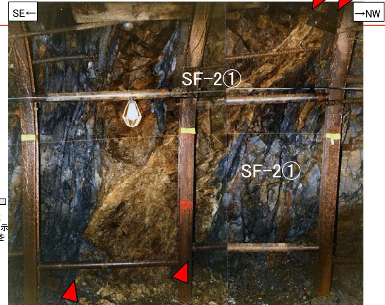
2号炉試掘坑A坑南西壁で確認したSF-2①断層(左:スケッチ, 右:写真)
