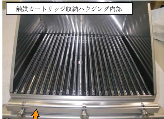
触媒カートリッジ収納ハウジング内部
