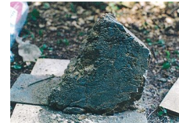
試料右壁面(破碎岩)
