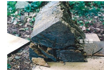
試料左壁面(破碎岩)
