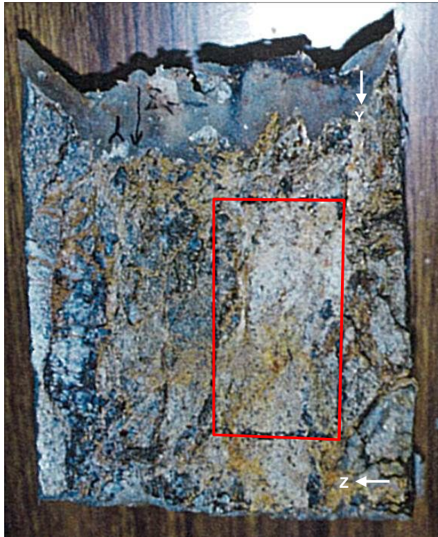
薄片試料作成位置 (YZ面) 薄片作成位置
