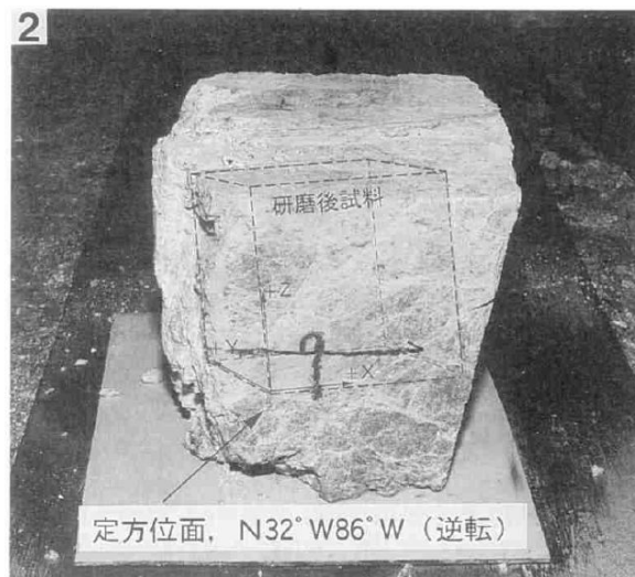
採取された破碎岩試料ブロックと試料の整形・研磨
