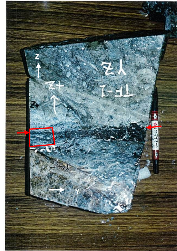
三面カット用試料 切り出し後の残試料 (薄片試料採取用)
