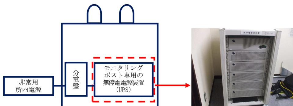
図 1 モニタリングポスト無停電電源装置の構成図
