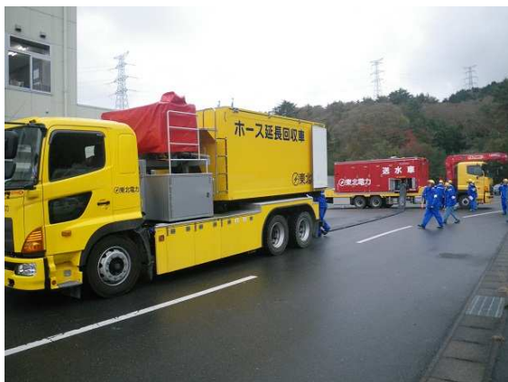
車両による海水送水ホースの設置
