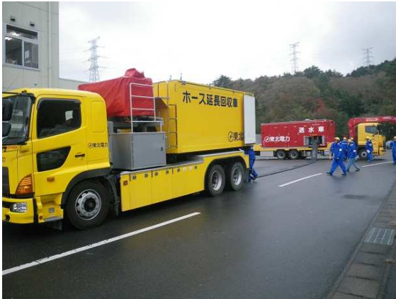
車両による送水用ホースの設置
