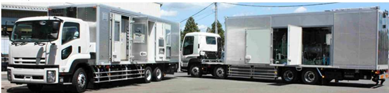
(同型ガスタービン発電機)
