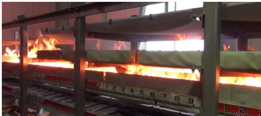
図 3 ケーブル火災状況
