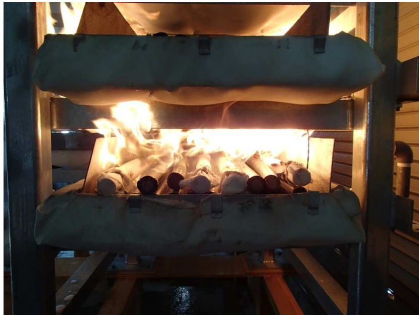
図 8 ケーブル火災状況
