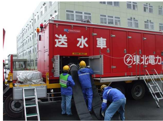
取水用ホースの接続
