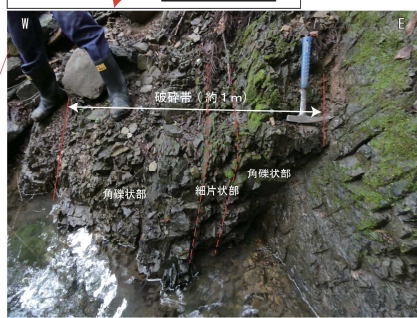
断層は、三畳系伊里前層の頁岩層を切断し、破砕帯は、幅約1mの細片状～角礫状で、明瞭な断層粘土は認められず、固結している。
