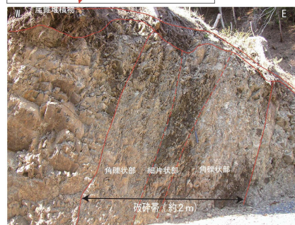
断層は、三畳系伊里前層の頁岩層（左）とジュラ系中原層の礫岩層（右）を境し、その破砕帯は、幅約2mの細片状～角礫状で、母岩と同等に風化している。母岩は、三畳系頁岩層よりジュラ系礫岩層の風化、軟質化が進んでいる。
