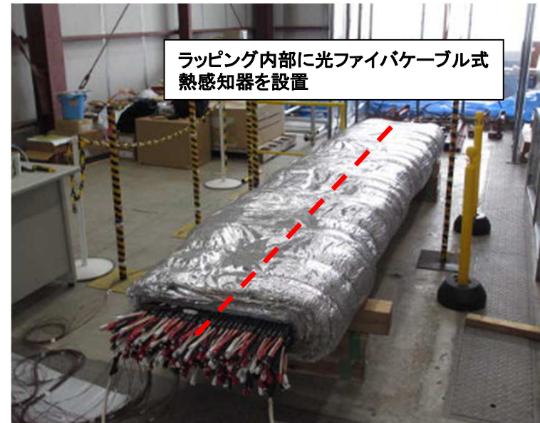
ケーブルトレイ3時間ラッピングの施工例
