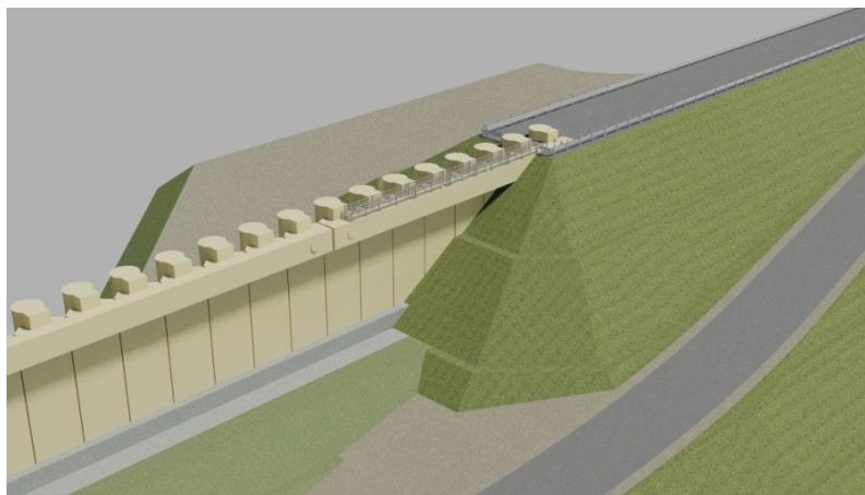
(鋼管式鉛直壁と盛土堤防の境界部周辺)
