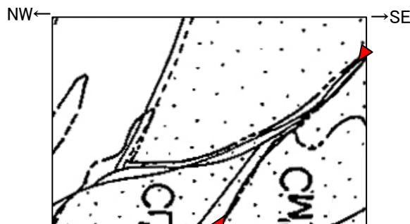
OF-7断層近傍 3号炉試掘坑1号坑北東壁スケッチ (展開図を反転)
