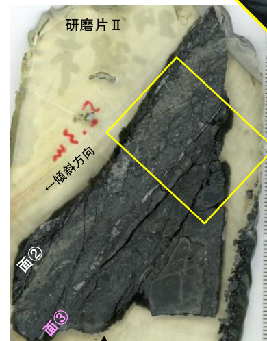
研磨片 I を紙面手前側約1cmの箇所まで切断し、作成
