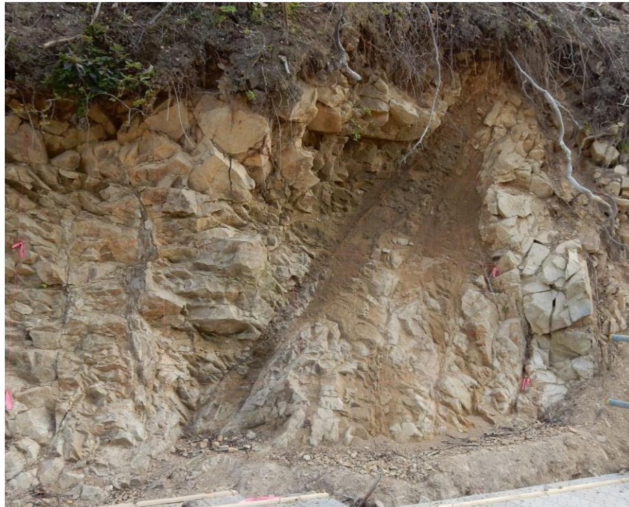
低角度の節理が発達。 節理沿いには石英が晶出していることが多い。
