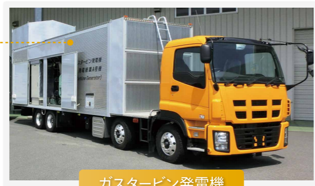
ガスタービン発電機
