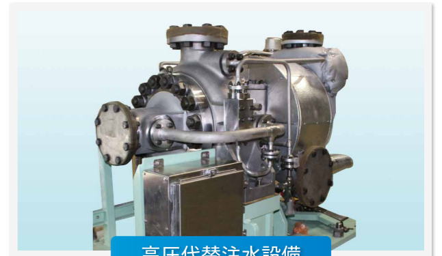
高圧代替注水設備
