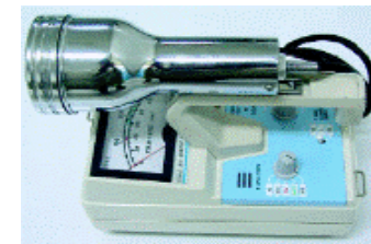
汚染密度測定用 サーベイメーター
