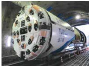
導水路掘削に使われている最新鋭のトンネルボーリングマシン（愛称「玉二郎」）
