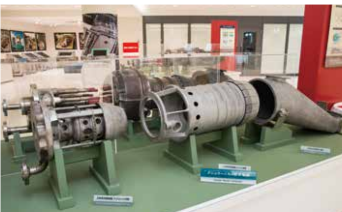
東新潟火力発電所内に展示されている、運転開始当時の低NOx燃焼器。「未来技術遺産」に登録され、当時の技術力の高さがあらためて評価された。
