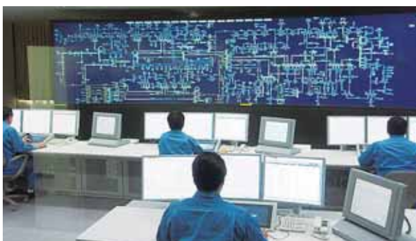
給電シミュレータ
