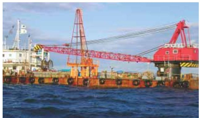
海底下の堆積物を採取・分析する海上ボーリング調査
