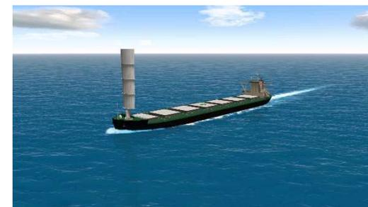
2022年度以降の運航開始を目指す硬翼帆式風力推進装置（windchallenger）搭載石炭船
